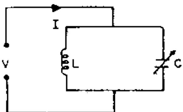
Nota: a) d) à frequência de ressonância ( $f_r$ ), a impedância ( $Z$ ) do circuito LC é máxima, pelo que a corrente  $I$  é mínima.
