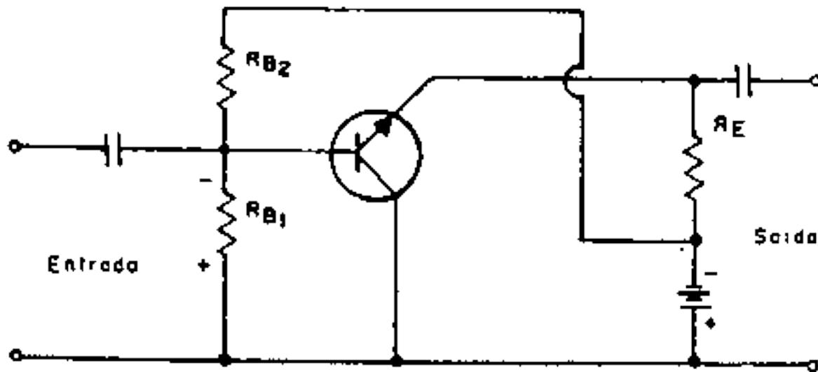
A polarização entre base e colector obtém-se pela queda de tensão em  $R_{B1}$  que torna a base negativa em relação ao colector (polarização inversa).
