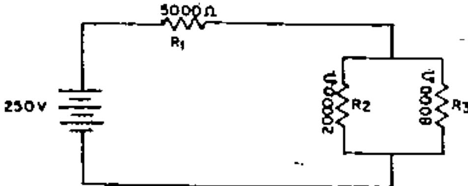
**Nota:** Vamos calcular a corrente total que atravessa o circuito. Para isso calculamos a Resistência total ( $R_t$ ) do circuito.
