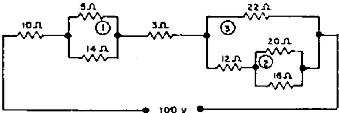
Notar: O cálculo da resistência equivalente dá: 27,4 Ω
